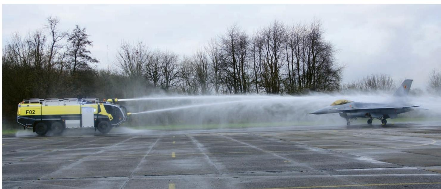
*Het op het dak aangebrachte sputtkanon kan vanaf 80 m ingezet worden, het vooraan geplaatste op 70m. Zichtbaar onder de brandweerwagen, de sprinklers die door de grond te besproeien het voertuig toelaten op brandend terrein te rijden.*
