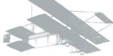
van 15,50 meter, en dat een snelheid van 65-70 km/u kan halen, en het «snelle militaire type», met een spanwijdte van 12 meter, en een snelheid van 90-95 km/u. Er wordt echter geen nummer gebruikt om een onderscheid te maken en de werkelijke spanwi-jtes zijn niet noodzakelijk degene die in de publicaties en op de
