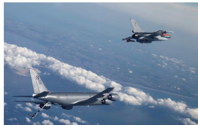
*Contact ! De boom van het bevoorradingsvliegtuig is verbonden met de F-16.*
