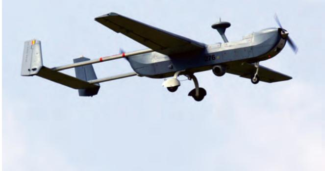
pollueur, surveiller l'évolution d'une nappe d'hydro carbure sont autant de missions dans lesquelles le B-Hunter et ses opérateurs excellent. Les avantages liés au drone sont indéniables : il reste en vol plus de 10 heures, opère silencieusement à 2000 mètres d'altitude de jour comme de nuit et surtout, la vidéo de la cible surveillée est retransmise en temps réel dans la salle des opéra-
