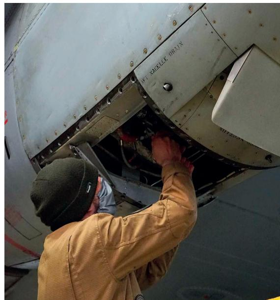
De afstelling van het "Temperature Datum Valve" die dient om de temperatuur aan de ingang van de turbine te meten TiT (Turbine Inlet Temperature).
