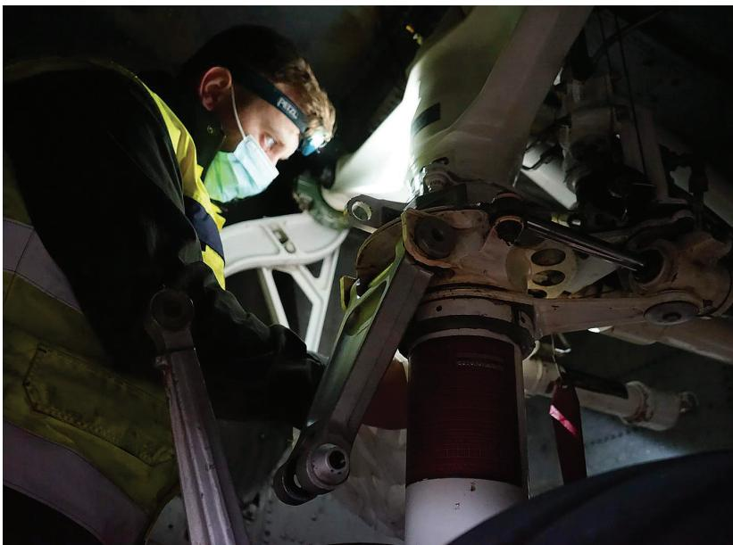
Herstelling van een hydraulisch lek aan de "nose wheel steering actuators".
